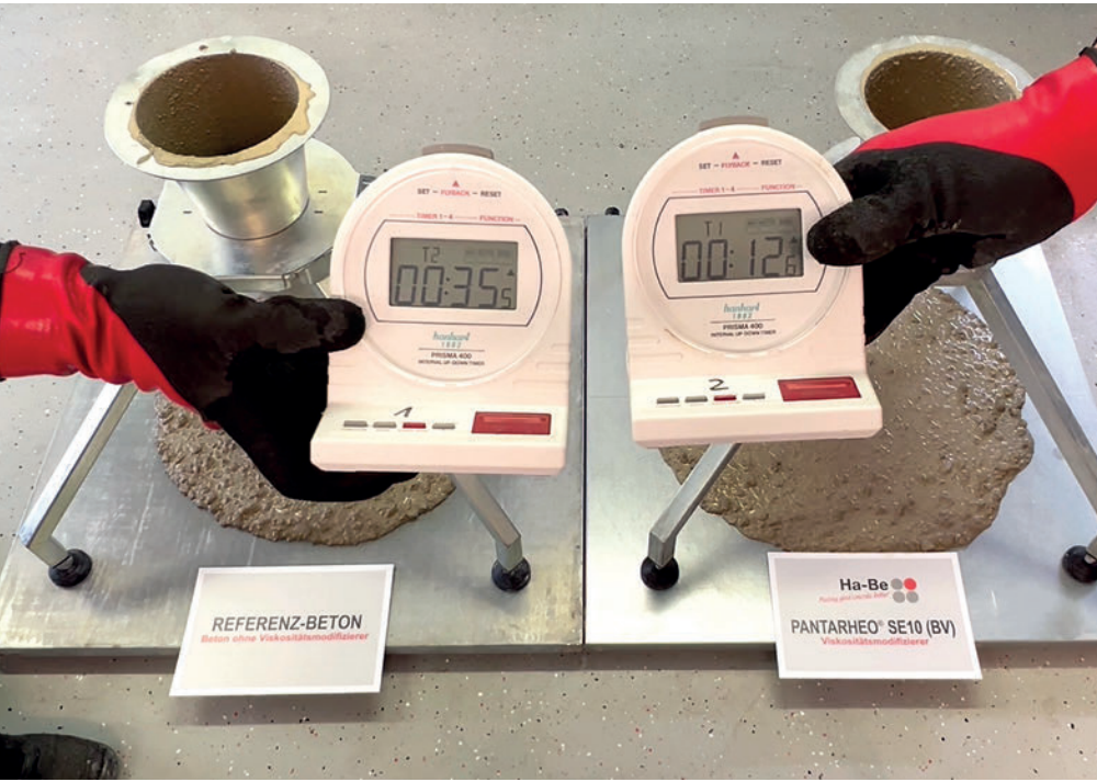
Vergleichsversuch zur Bestimmung der Fließgeschwindigkeit mit Pantarheo SE10 (BV)
